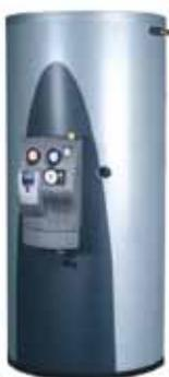
Serbatoio/scambiatore termico di tipo COMBI, per la produzione di acqua calda sanitaria ed integrazione del riscaldamento ambiente a bassa temperatura. Isolato termicamente con poliuretano espanso rigido removibile privo di CFC, dotato di anodo di magnesio e certificato secondo DIN 4753 ed EN 12975.
