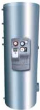
Serbatoio/scambiatore termico a doppia serpentina\* per la produzione di acqua calda sanitaria. Isolato termicamente con poliuretano espanso rigido privo di CFC, dotato di anodo di magnesio e certificato secondo DIN 4753 ed EN 12975.
