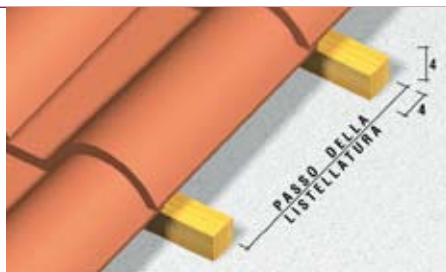
Fig. 1: Dimensioni tipo dell'elemento di supporto (listelli in legno) delle tegole. Passo della listellatura variabile. Fig. 1: "Typical" dimensions of the tile support element (timber battens). The batten gauge can be varied.
