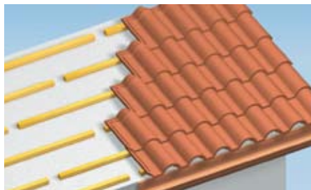
Fig. 2: Le linee di supporto delle tegole (listelli o cordoli) andranno disposte parallelamente alla linea di gronda ed interrotte per 3-4 cm ogni 3-4 metri. Fig. 2: The tile supports (battens or fillets) must be laid parallel to the eaves course with gaps of 3-4 cm every 3-4 metres.
