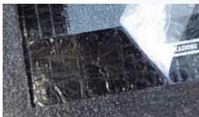
Processo di produzione brevettato, per la realizzazione di membrane autoprotette con graniglie minerali e aree di sovrapposizione (cimose) longitudinali e trasversali libere da graniglia.
