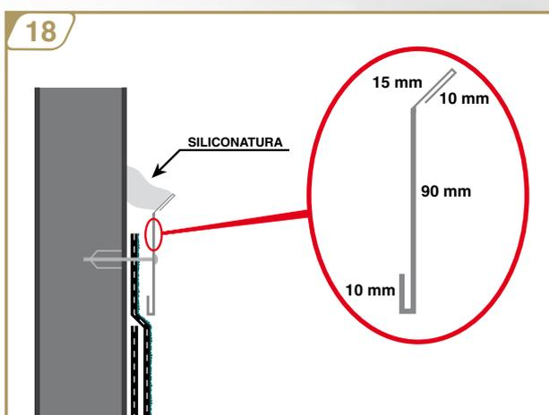
4. Per risvolti verticali superiori ai 30 cm, si consiglia il fissaggio meccanico del telo sotto sormonta, mediante tassello e rondella metallica, da ricoprire con il telo successivo (sotto sormonta).
