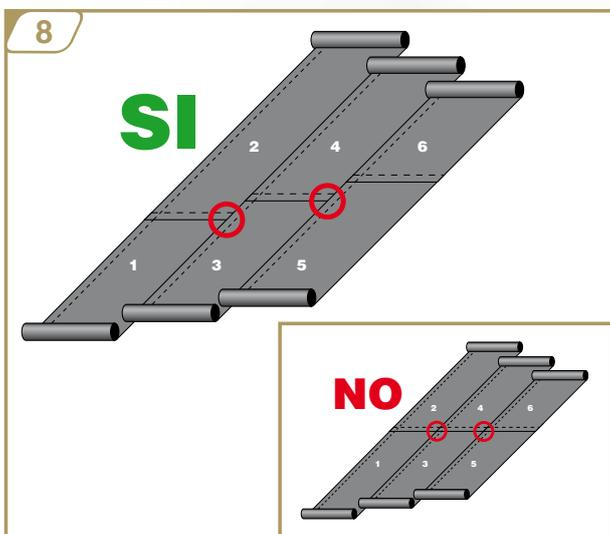
11. Tutte le membrane del secondo strato impermeabile, devono essere posate in opera nello stesso verso di quello del primo strato, a cavallo delle sovrapposizioni sia di testa che laterali. (immagine 9)
