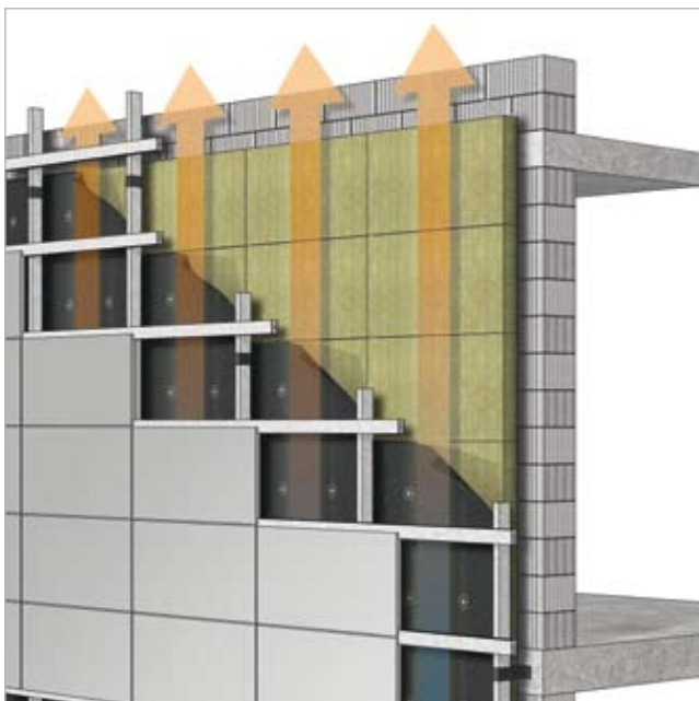
COMPORTAMENTO ESTIVO Il flusso d'aria all'interno dell'intercapedine ventilata permette di migliorare le prestazioni termiche estive.
