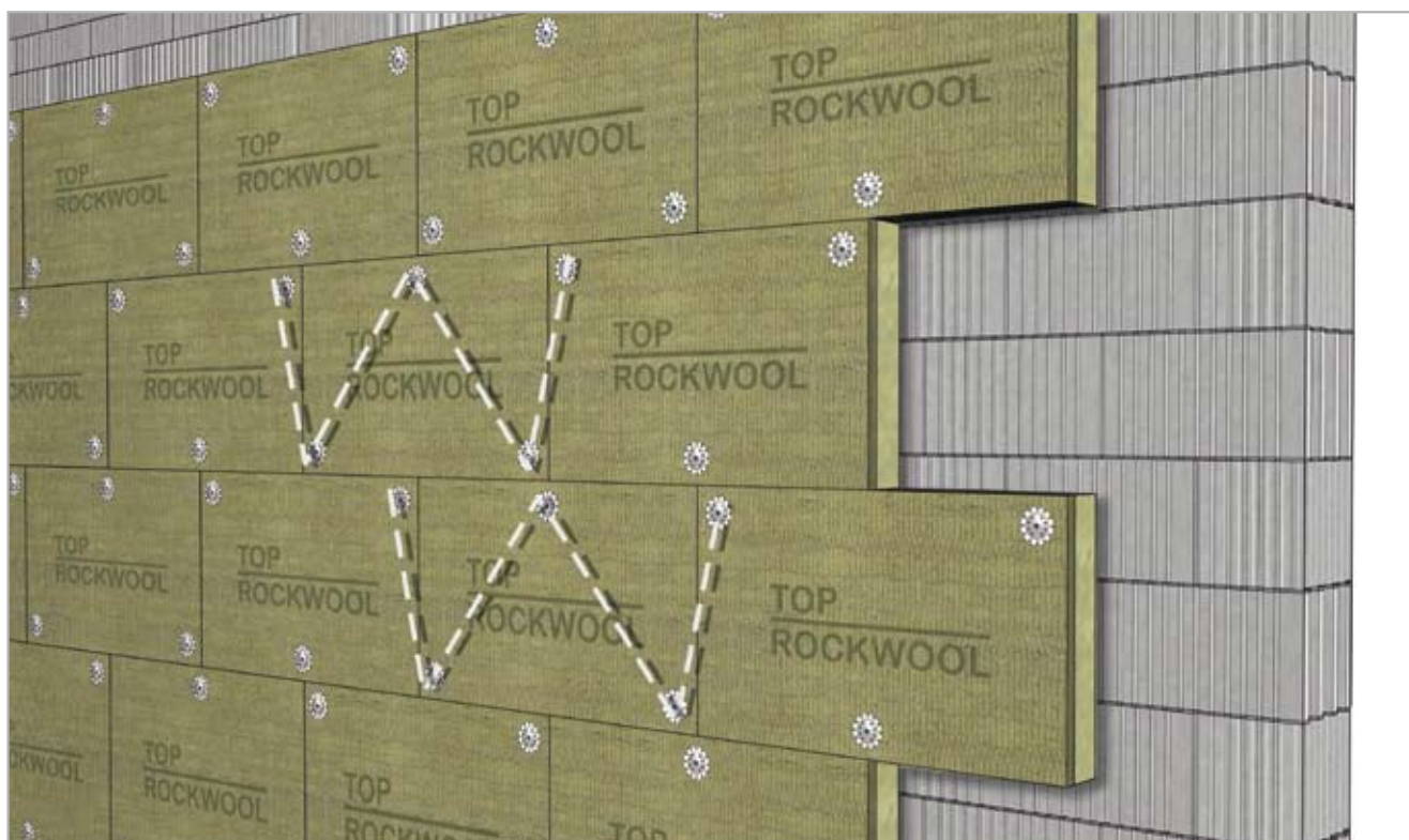
SCHEMA DI FISSAGGIO A "W"
