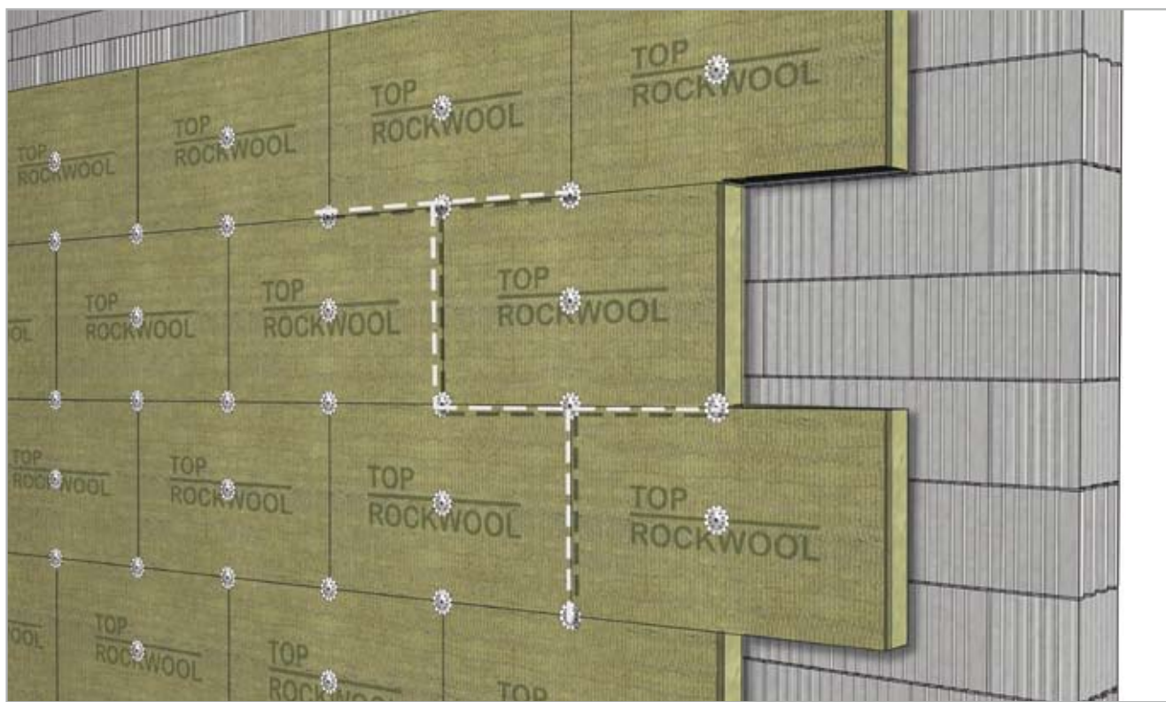
SCHEMA DI FISSAGGIO A "T"
